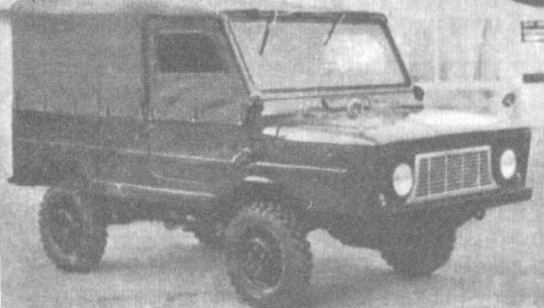
Фото 10. Полноприводный грузопассажирский автомобиль ЛуАЗ-969 (4x4) выпускался в г. Луцк в 1971–1975 гг.
