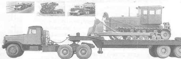
ЭТО АВТОМОБИЛЬ-ТРАКТОР КраЗ-258, КОТОРЫМ МОЖЕТ ВЫКОНУВАТИ ВОЗРОПРАЦЮ НАВНУТРИ РАЙОНУ ДО 20 ТОНН C'EST LE КраЗ-258, UN CAMION-TRACTEUR, QUI PEUT TRAINER UNE SEMI-REMORQUE DE POIDS TOTAL DE 20 T
